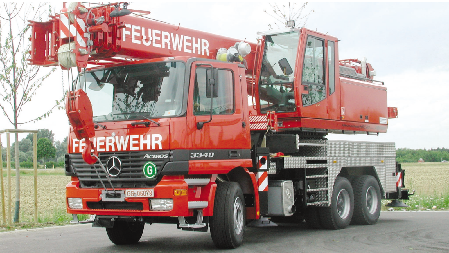
HPC 40 in Feuerwehrausführung auf DaimlerChrysler Actros 3340 6x6 HPC 40 Version for the fire brigade on Daimler Chrysler Actros 3340 6x6
