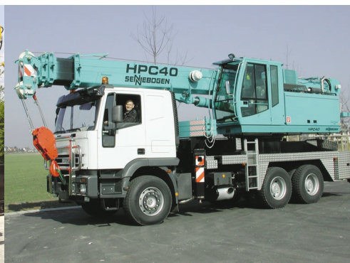
HPC 40 auf/on IVECO MP 380 E 6x4 mit Fernfahrerhaus/with long-distance driving
