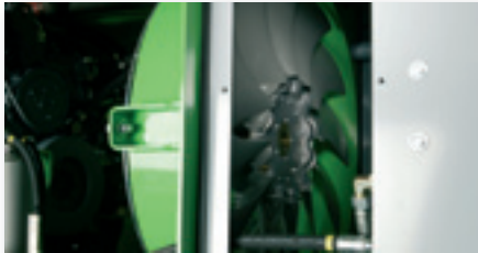
Die Kühlbox mit 3-Kreis Kühlsystem für Ladeluft-, Wasser- und Ölkühlung The cool-box with 3-circuit cooling system for charge air, water and oil cooling
