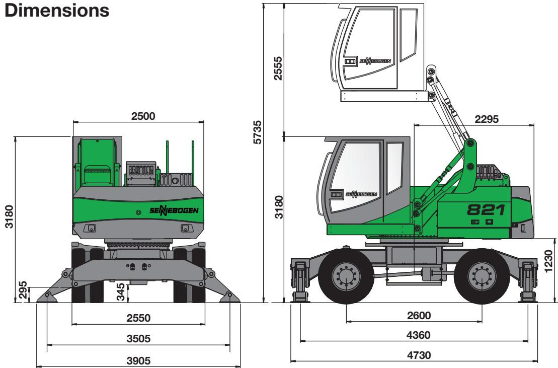
**821 M mit hydraulisch um 2700 mm hochfahrbarer Kabine Typ C 270**
