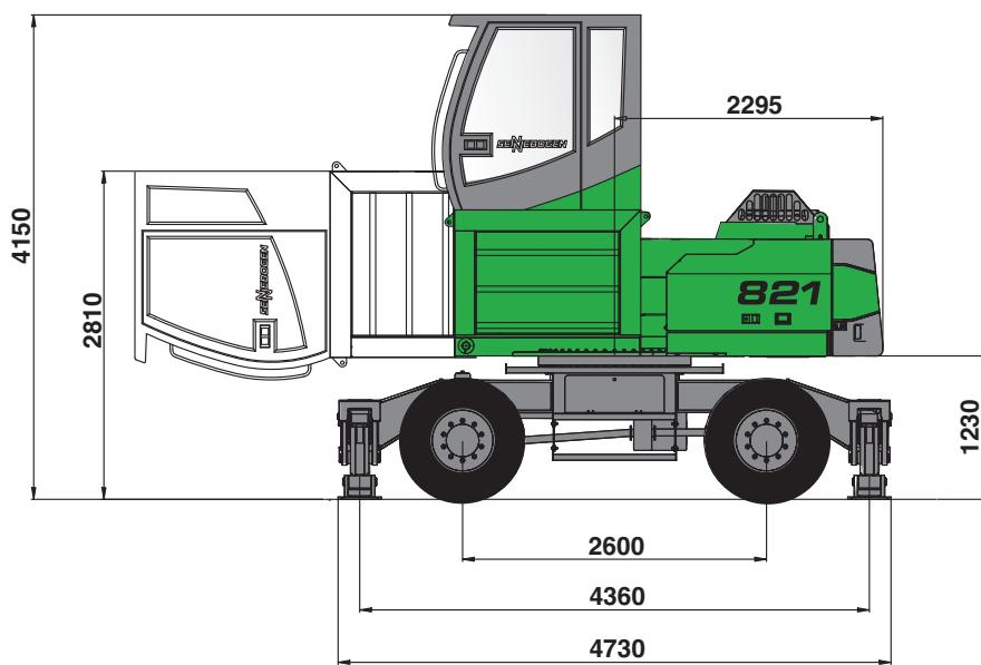
**821 M mit starr hochgesetzter Kabine, Erhöhung 1000 mm, auf Wunsch 1500 mm, mechanisch oder auf Wunsch hydraulisch nach vorne abklappbar.**
