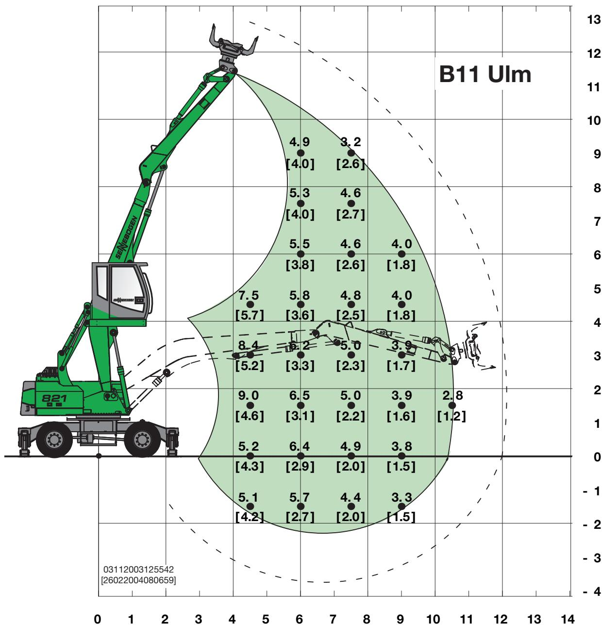
Mit abgebautem Umlenkmechanismus erhöhen sich die Traglasten um ca. 250 kg.
