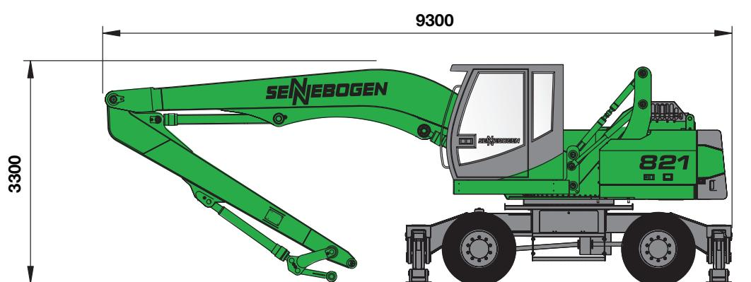
**821M mit Kompaktausleger 6,4 m spezial Ladestiel 4,2 m mit Umlenkmechanismus**
