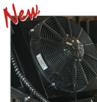
Heat exchanger. Cambiador de calor.
