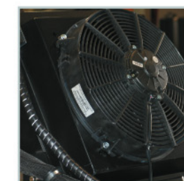
Heat exchanger Cambiador de calor
