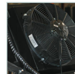
Heat exchanger Cambiador de calor
