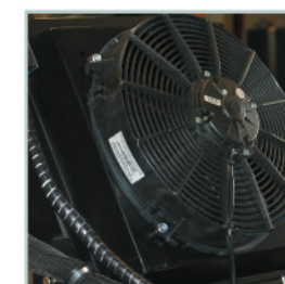
Heat exchanger Cambiador de calor
