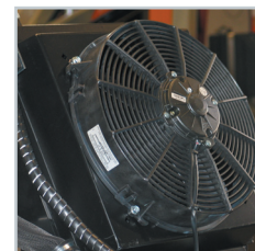
Heat exchanger. Cambiador de calor.
