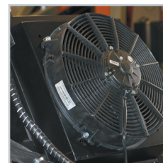
Heat exchanger. Cambiador de calor.
