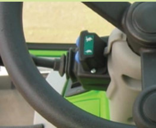
Der Fahrrichtungshebel mit dem Finger-Touch-System seitlich des Lenkers, ermöglicht dem Fahrer, umzuschalten, ohne die Hände vom Lenkrad zu nehmen.
