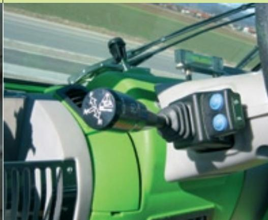
Der elektronische Joystick gestattet die Änderung der Hubgeschwindigkeit und des Ausfahrens des Hubarms abhängig vom Gewicht der umgeschlagenen Last.
