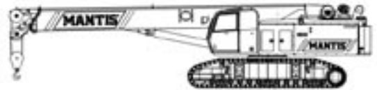
9010 - 45 US TON CRAWLER
