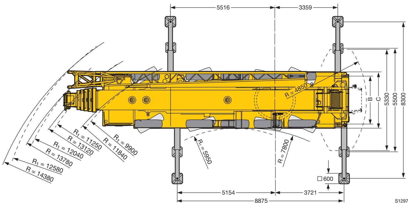
R<sub>1</sub> = mit unabhängiger Hinterachslenkung / with independent rear-axle steering / à direction essieu arrière indépendante
