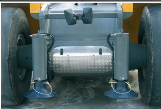
Abstützplatten für erhöhte Tragfähigkeiten in der zweiten und dritten Reihe (optional).
