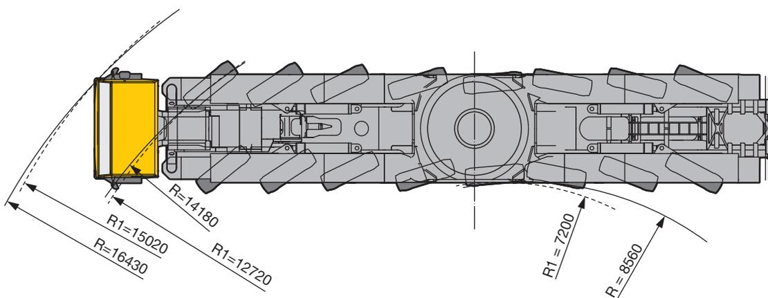
R<sub>1</sub> = Allradlenkung · All-wheel steering · Direction toutes roues · Tutti gli assi sterzanti · Dirección en todos los ejes · Поворот всеми колесами
