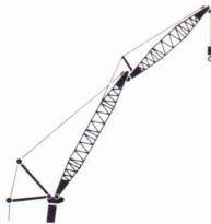
■ 31mブーム+5.65m+45m+15mエクステンションジブ (A性能)
