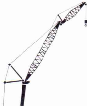
■ 31mブーム+5.65m+45m+15mエクステンションジブ (A性能)
