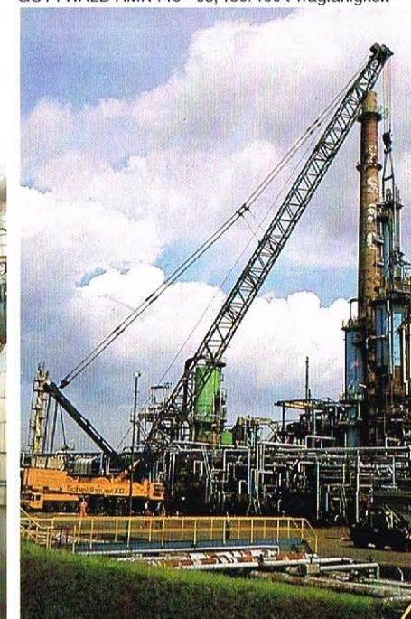
GOTTWALD AK 850, 800/850 t Tragfähigkeit
