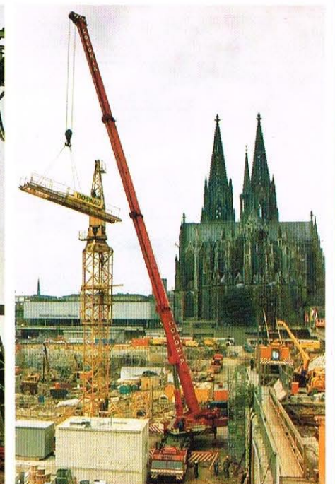
GOTTWALD AMK 200-83, 200/230 t Tragfähigkeit
