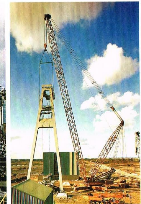
GOTTWALD AK 680, 650/850 t Tragfähigkeit
