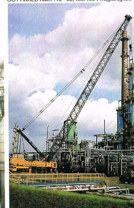
GOTTWALD AK 850, 800/850 t Tragfähigkeit
