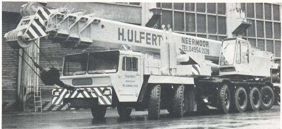
GOTTWALD Teleskop-Autokran AMK 125-63 mit 100/125 t Tragfähigkeit
