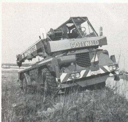
GOTTWALD Teleskop-Autokran AMK 46-21 mit 25/27,5 t Tragfähigkeit
