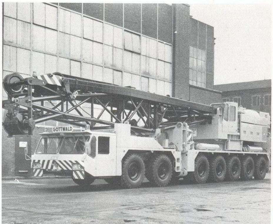
GOTTWALD Gittermast-Autokran AK 210-73 mit 180/225 t Tragfähigkeit
