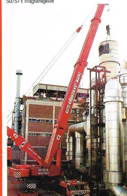
GOTTWALD AMK 400-93, 400/500 t Tragfähigkeit
