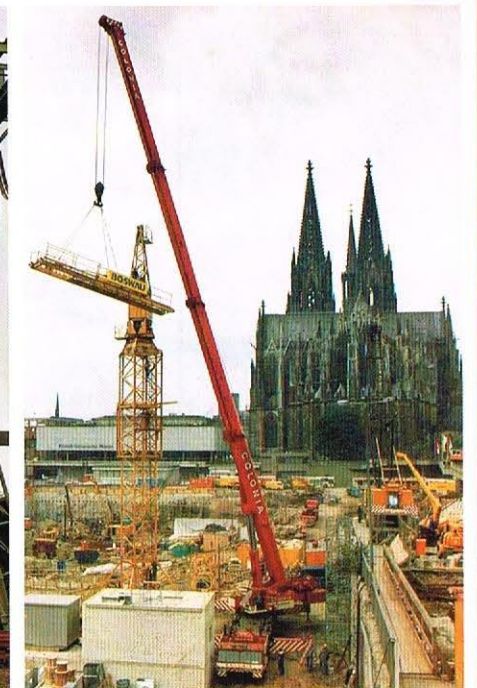
GOTTWALD AMK 200-83, 200/230 t Tragfähigkeit
