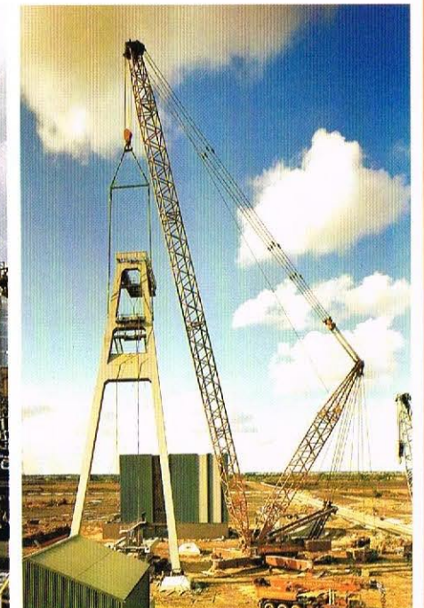
GOTTWALD AK 680, 650/850 t Tragfähigkeit
