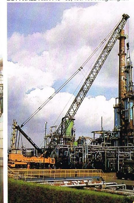
GOTTWALD AK 850, 800/850 t Tragfähigkeit
