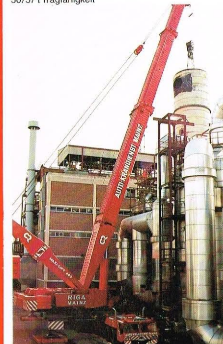
GOTTWALD AMK 400-93, 400/500 t Tragfähigkeit
