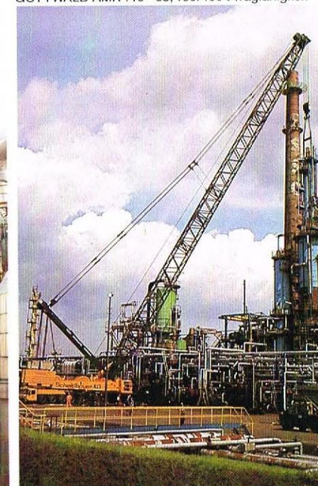
GOTTWALD AK 850, 800/850 t Tragfähigkeit
