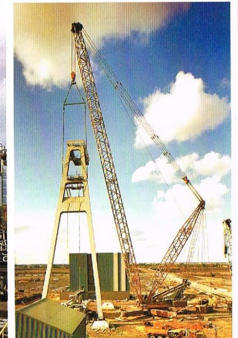
GOTTWALD AK 680, 650/850 t Tragfähigkeit
