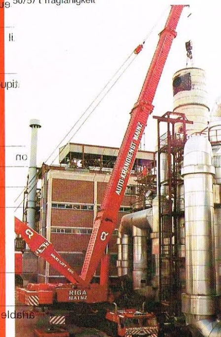
GOTTWALD AMK 400-93, 400/500 t Tragfähigkeit
