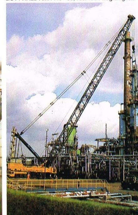
GOTTWALD AK 850, 800/850 t Tragfähigkeit
