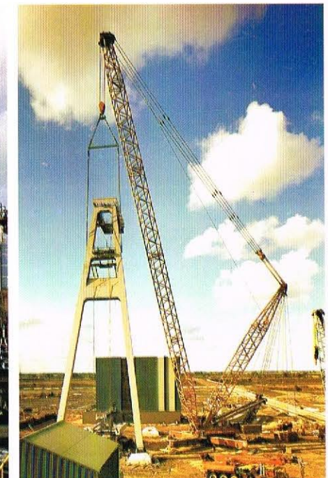
GOTTWALD AK 680, 650/850 t Tragfähigkeit
