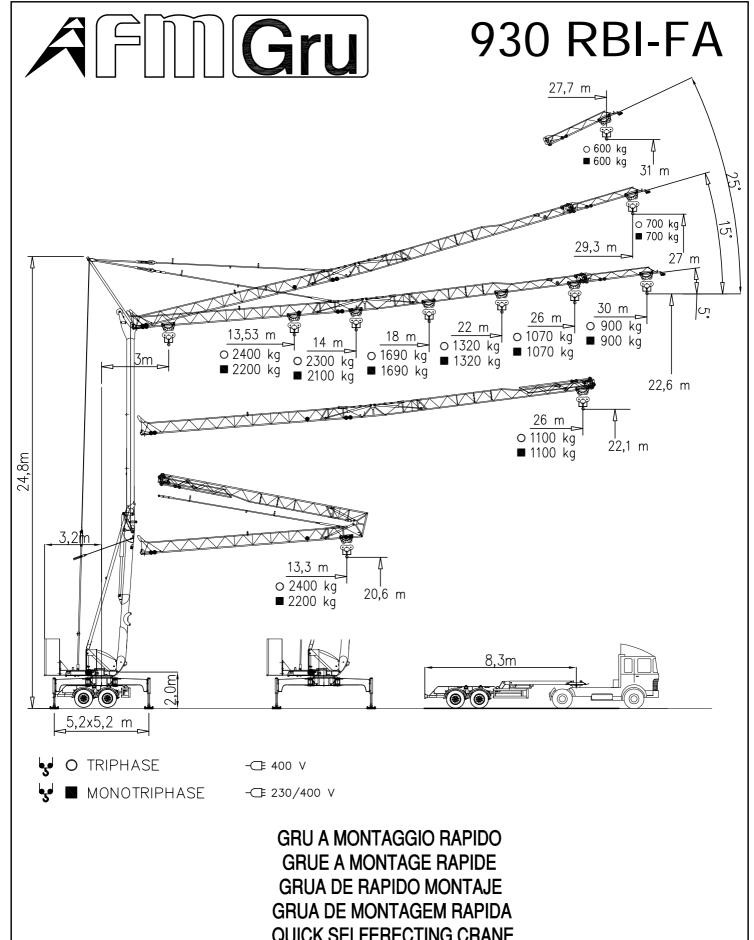
QUICK SELFERECTING CRANE HYDRAULISCHER SCHNELLMONTAGEKRAN
