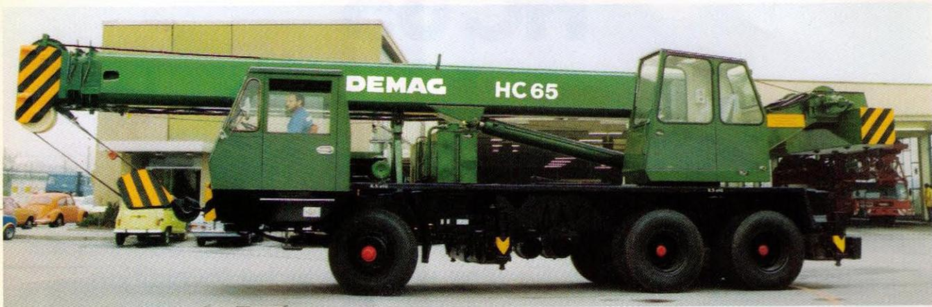
Der Demag-Teleskopkran HC 65 repräsentiert den modernen Typ des schnellen, vielseitigen Autokrans. Seine Höchstgeschwindigkeit von 73 km/h sorgt für kurze Anfahrzeiten. Mit 43 Prozent Steigfähigkeit,
