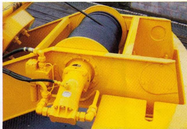
Die Hubwerkseinheit mit Hydromotor, Planetengetriebe und Lamellenbremse liegt hoch und sorgt so für eine gradlinige Seilführung. Serienmäßig vorgeplant: der Einbau einer zweiten Hubwerkswinde für den Zwei-Seil-Betrieb.
