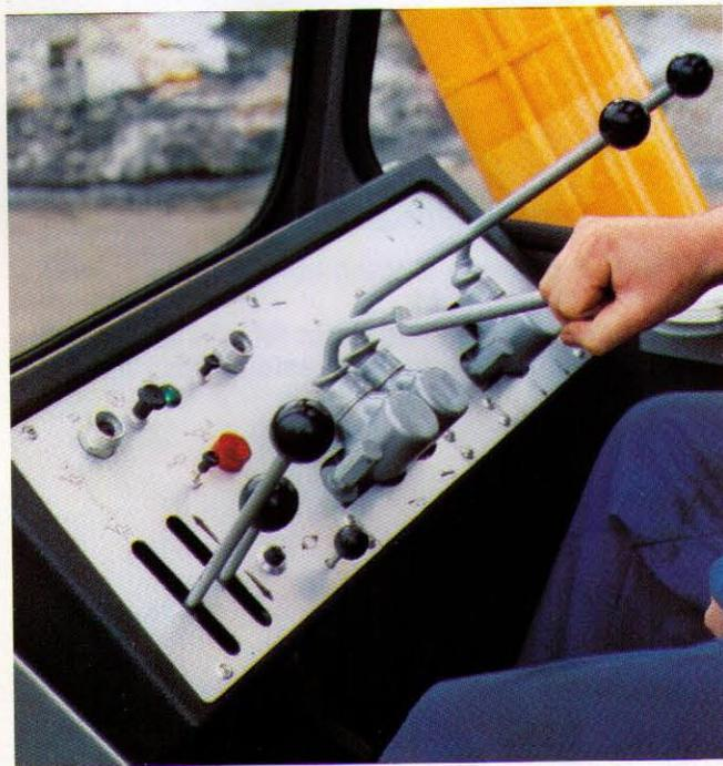
Qualität auch im Detail. Funktionsgerechte Hebel mit kurzen Wegen machen es leicht, die technischen Vorteile der Dreikreis-Hydraulik voll auszunutzen. Die Hebel und Kontrollinstrumente am gepolsterten Steuerpult besitzen unverwechselbare Kennzeichnungen.
