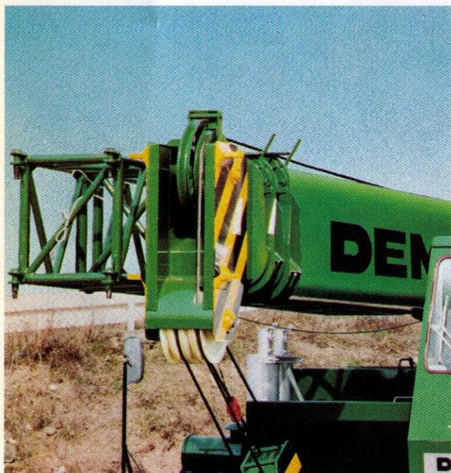
Der Hubenschalter verhindert Beschädigungen durch Anschläge der Unterflasche am Rollenkopf. Als Sondereinrichtung sichert ein Senkenschalter das Seil gegen Abreißen von der Trommel und Beschädigung durch falsches Aufspulen.
