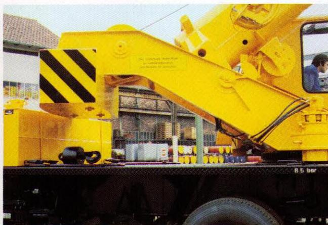
Für bequeme, zeitsparende Wartung wurden alle Aggregate des Oberwagens leicht zugänglich und ohne überflüssige Verkleidungen angeordnet. Alle Schmierstellen sind ungehindert erreichbar.
