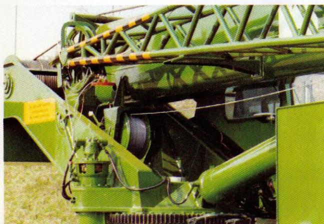
Die Stützen mit mechanischer Sicherheits-Arretierung lassen sich von jeder Fahrgestellseite aus einzeln steuern. Mit ihrer Hilfe können auch die Reifen gewechselt werden. Der Reservereifen besitzt eine eigene Hilfswinde am Fahrgestell.
