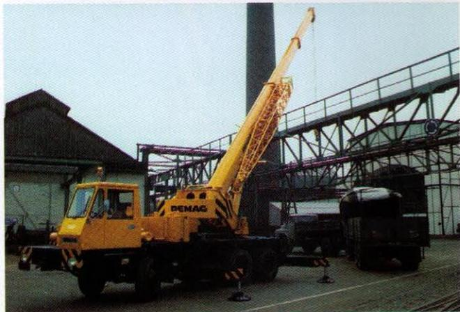
Die großzügig dimensionierte Abstützbasis von 4,57 x 5,20 m gibt dem HC 65 eine hohe Standfestigkeit. Das konstruktive Fundament für seine überdurchschnittliche Hubleistung.
