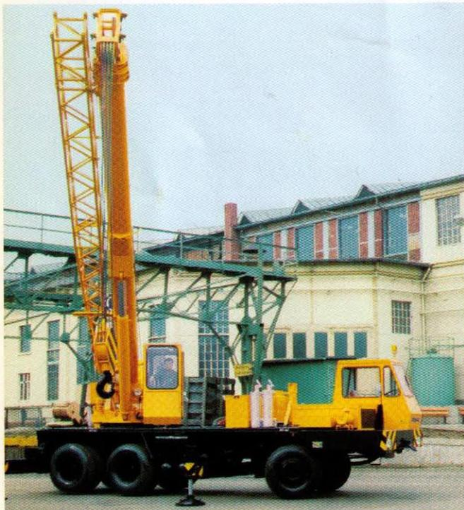
So schnell wie er kommt, so flink ist der Demag-Teleskopkran HC 65 auch einsatzbereit. Der Hauptausleger ist unter Last bis 24,3 Meter teleskopierbar. Der Drehbereich beträgt uneingeschränkt 360°. Mit einer 9-m-Verlängerung erreicht der Hauptausleger eine maximale Rollenhöhe von 35,70 Meter. Das Richtige für alle, die hoch hinaus müssen. Der Wippzylinder vorn erlaubt eine große Steilstellung des Auslegers bis 82°.
