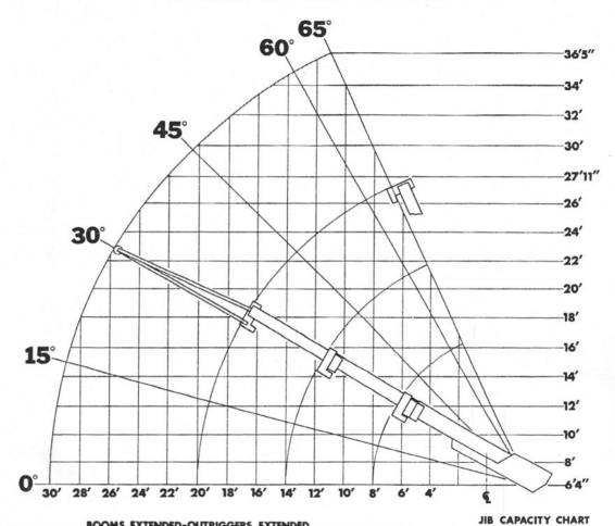
BOOMS EXTENDED-OUTRIGGERS EXTENDED BOOM RADIUS 8 10 12 14 16 20 23 27 30 1225 LOAD - POUNDS 12000 11000 8400 7400 5900 4650 3800 3100 2700 2350 BOOMS EXTENDED-OUTRIGGERS RETRACTED 30 12
